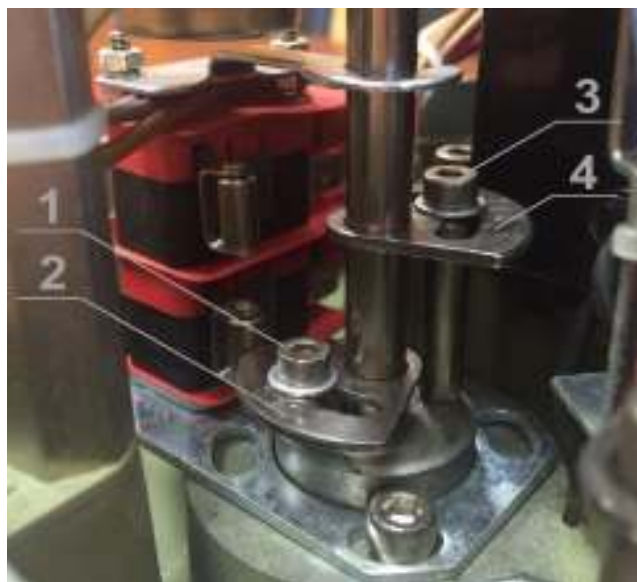
Рис. 3. Блок конечных выключателей
